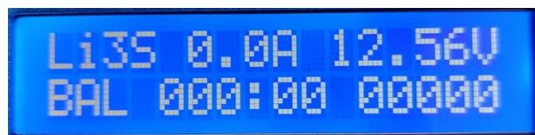
Figur 8. Nu laddar batteriet. Tryck på Stop (röd text) för att avbryta laddningen. (OBS: Avbryt alltid laddningen innan ni drar ut sladdarna.)
