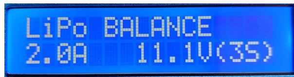
Figur 5. Se till att laddaren är i BALANCE läget. Byt läge genom att trycka på Inc. eller Dec. knapparna. Håll sedan in Start knappen tills att laddaren låter för att starta laddning.
