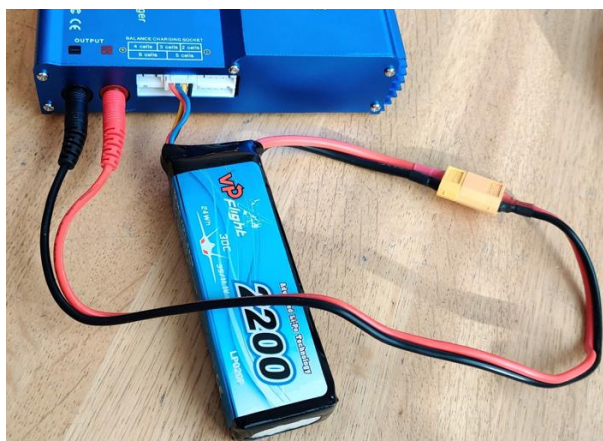
Figur 4. Så här ser det ut om batteriet är korrekt inkopplat. (OBS: Ladda aldrig batteriet utan att ligga i en laddpåse.)
