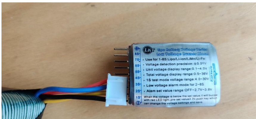
Figur 1. Så här kopplas batterivarnaren till batteriet. (Tips: Varnaren pipar högt när den kopplas in så håll för högtalarna när ni stoppar i kontakterna så låter det mindre.)
