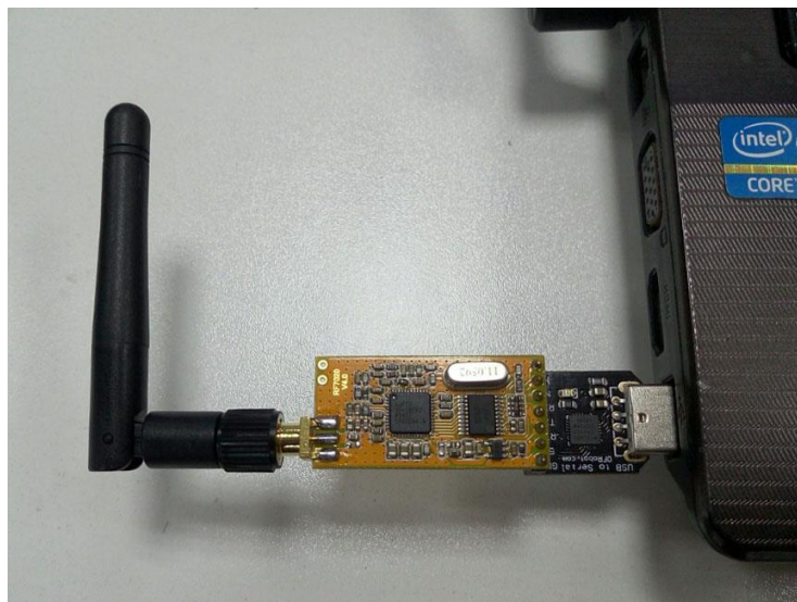
Figur 1. Radiomodulen med en böjd pin inkopplad via en USB-UART adapter.
