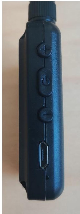
Figur 2. Kameramottagare med strömknapp i mitten, plusknapp för att byta frekvensband och minusknapp för att byta frekvens inom det valda bandet.
