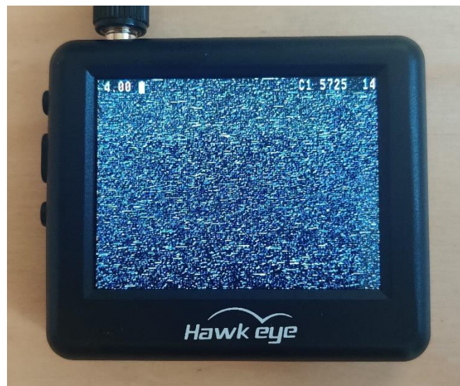
Figur 1. Kameramottagare inställd på 5725 MHz. Bokstaven C visar att mottagaren är inställd på frekvensband A vilket används av alla lags kameror.
