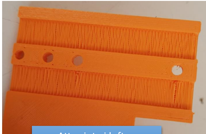
Att printa i luften resulterar i "overhang"
